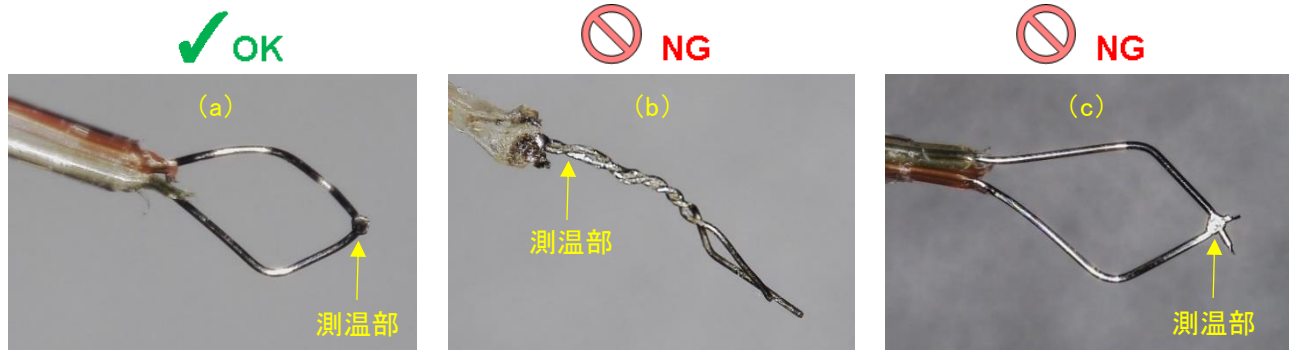
図 3. 熱電対の測温位置
