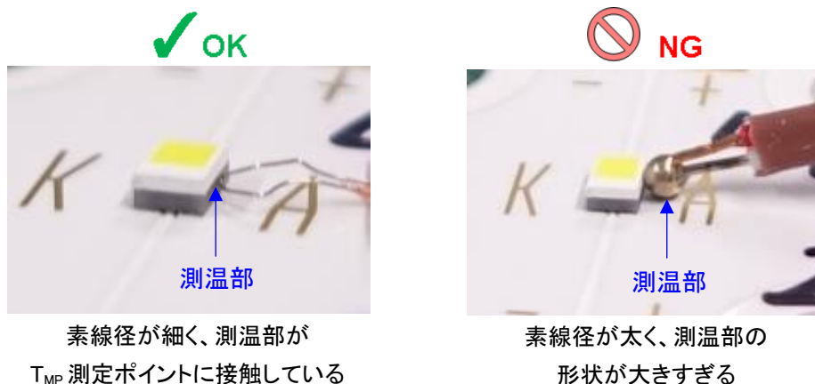
図 2. 熱電対取り付けの例(接着剤塗布前)
